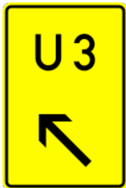
455.1-11 Fortsetzung der Umleitung (links vorbei)
