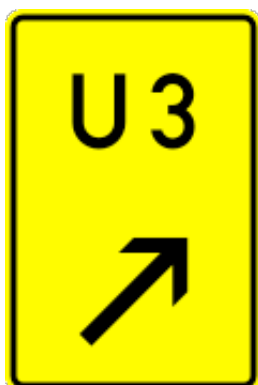
455.1-21 Fortsetzung der Umleitung (rechts vorbei)
