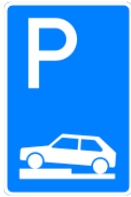
315-70 Parken halb auf Gehwegen quer zur Fahrtrichtung links
