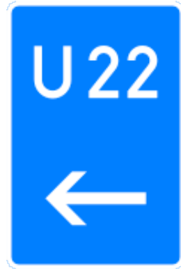
460-11 Bedarfsumleitung (hier links)
