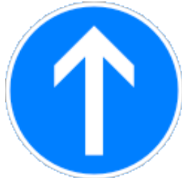
209-30 vorgeschriebene Fahrrichtung - geradeaus
