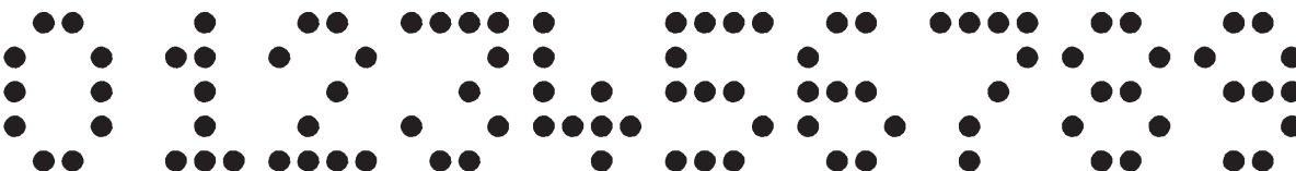
20 mm, 4 x 5 Punkte, Ø Nadel 2,3 mm
